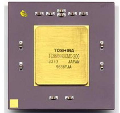
Un microprocessore MIPS R4400 fabbricato da Toshiba
