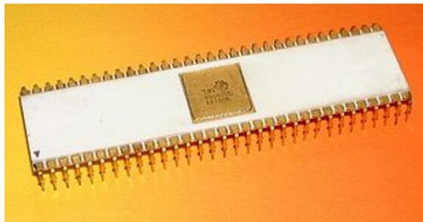
Il TMS-9900 il primo microprocessore a 16 bit su singolo chip
