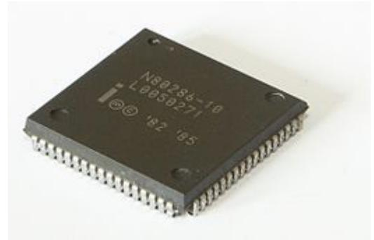
L'Intel 80286, un microprocessore monolitico sviluppato negli anni ottanta del XX secolo.
