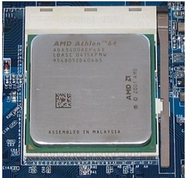
L'Athlon 64, prima CPU a 64 bit compatibile con l'architettura x86
