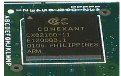
Un processore ARM Conexant utilizzato da molti router
